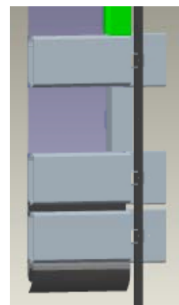
Seitlich angeordnete flexible Hochleistungszugelemente untereinander verbunden.
